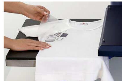
6 Una vez que el producto esté al menos caliente al tacto, podrá desprenderse la película transparente tirando de ella en un ángulo cerrado.
